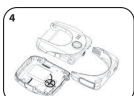
Utiliza un destornillador Phillips pequeño (no incluido) para quitar los cuatro tornillos de la parte frontal de la cámara.
