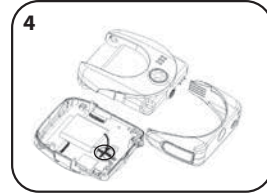
Verwenden Sie eine Schere, um die schwarzen und roten Drähte EINEN NACH DEM ANDEREN durchzuschneiden. Decken Sie die Drähte/Anschlüsse mit Isolierband ab und entsorgen Sie die Batterie ordnungsgemäß.
