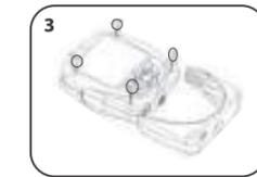
À l'aide d'un petit tournevis cruciforme (non inclus), retirez les quatre vis sur le devant de l'appareil photo/la caméra.
